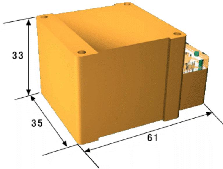
GH1电感式接近开关 ( )
