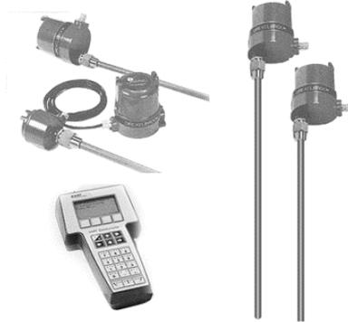
UDE-508 系列射频导纳物位计是一种新颖的物位测量仪表，它采用先进的射频导纳技术，克服了电容式物位计不能消除导电挂料影响的缺陷，仪表具有测量范围大（最大 61m）、精度高、安装方便等优点。适用于各种液体、浆料和颗粒料的物位测量以及两种液体的界面测量，尤其是油水界面的测量。仪表广泛用于石油、化工、冶金、医药、电力、食品、造纸等工业领域。
